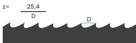
CONTINUO: Misurare col calibro la distanza tra dente e dente = X mm; 25,4 : X = Z oppure contare quante punte del dente sono comprese in un intervallo tra gola e gola di 25,4 mm.
