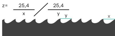
VARIABLE: misurare col calibro la distanza tra punta e punta del dente più grosso = x mm; 25,4:x = Z1 e quindi del dente più piccolo - lo = y mm; 25,4 : y = Z2. Passo alternato: Z1/ Z2
